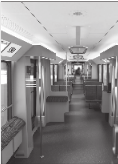
Visualisierungen des neuen Fahrzeugs (Tricon AG): Der S-DT 8.16 bietet nicht nur mehr Platz für Gepäck, Kinderwagen, Rollatoren und Lehnhilfen für bequemes Stehen, sondern auch volle Bewegungsfreiheit im Einstiegsbereich und eine abgesenkte Einstieghöhe.
