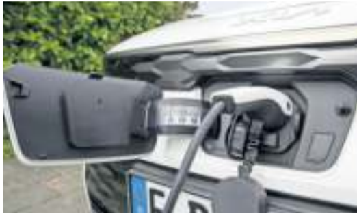
Der Kia Niro EV wird an der Front geladen (großes Foto oben und rechts unten). Unter der Fronthaube verbirgt sich ein kleiner Frunk (rechts oben), in dem das Ladekabel verstaut werden kann. Fotos: Kia
