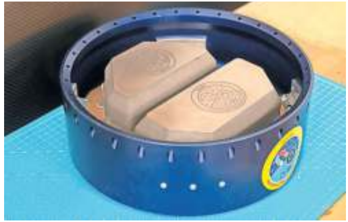
Das Experiment verschlossen, eingebaut im REXUS-Modul. Die Oberflächenstrukturen sind aus 3-D-gedrucktem Titan. Foto: Leon Habermalz/KSat e. V.
