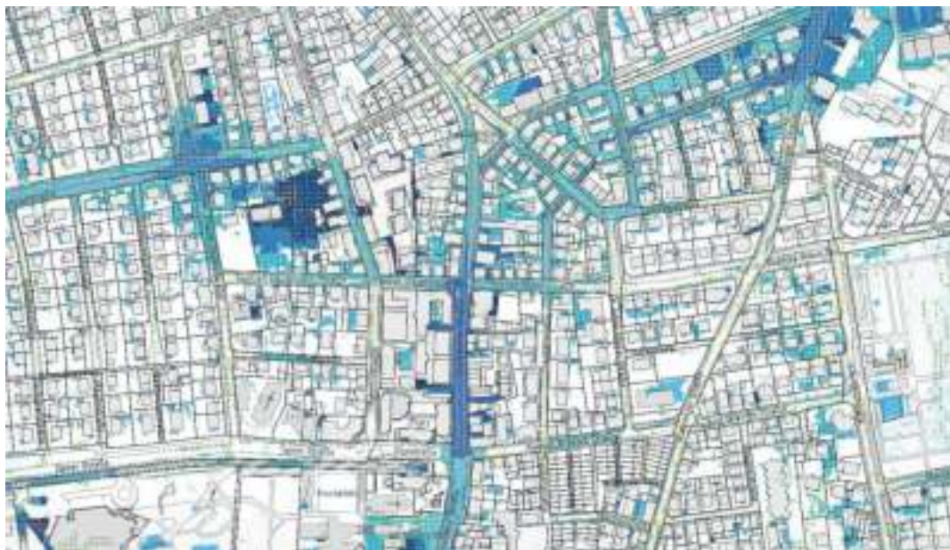
Unter anderem Teile der Bahnhofstraße sowie der Cannstatter Straße sind auf der Fellbacher Starkregengefahrenkarte dunkelblau eingefärbt. Das bedeutet: bei einem außergewöhnlichen Starkregenereignis kann hier das Wasser über einen Meter hoch ansteigen. Abbildung: Stadt Fellbach
