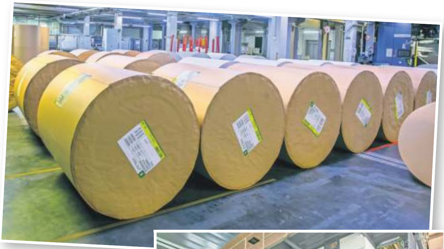
Für die Produktion des Fellbacher Wochenblatts am Standort in Esslingen werden eine Vielzahl an Papierrollen benötigt (oben). Der Druck auf der modernen Maschine erfolgt im sogenannten Rollen-Offset-Verfahren.
