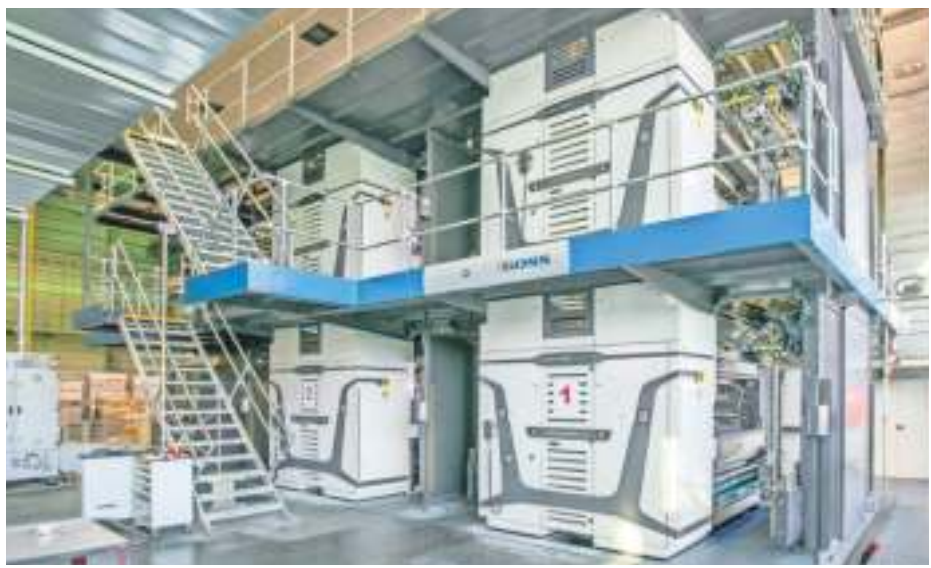
Für die Produktion des Fellbacher Wochenblatts am Standort in Esslingen werden eine Vielzahl an Papierrollen benötigt (oben). Der Druck auf der modernen Maschine erfolgt im sogenannten Rollen-Offset-Verfahren.
