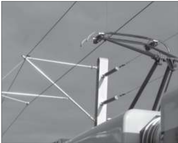
Fahrradt und Pantograph, also Stromabnehmer am Fahrzeug: Für den elektrischen Schienenverkehr mit seinen großen Fahrzeugeinheiten eine interessante Sache
